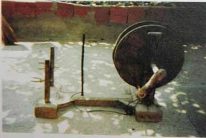
Resim 39 : İp ( Kıl) bükmeye yarayan ve çıkrik adı verilen alet
