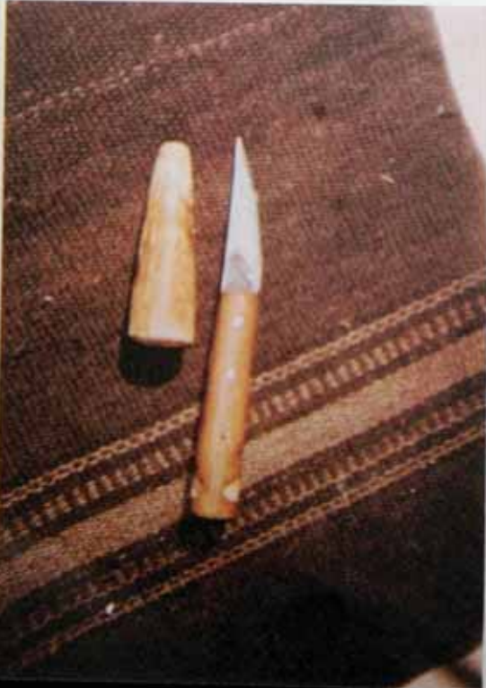
Resim 32 : Kaşık oymak için kullanılan bıçak.
