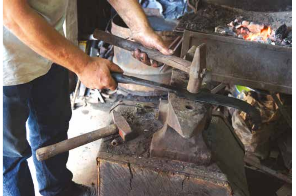
Fotoğraf-95: Demir tahranın yapımı-Muratpaşa İlçesi
