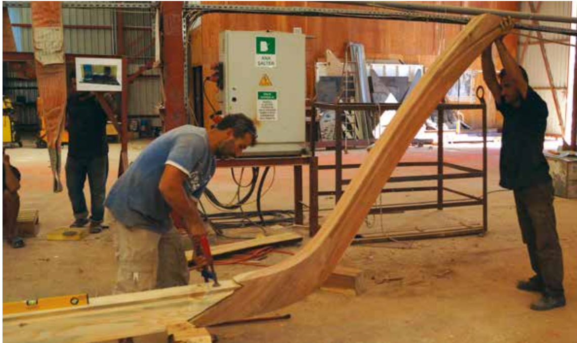
Fotoğraf-8: Teknenin başbodoslamasının yerleştirilmesi-Manavgat İlçesi
