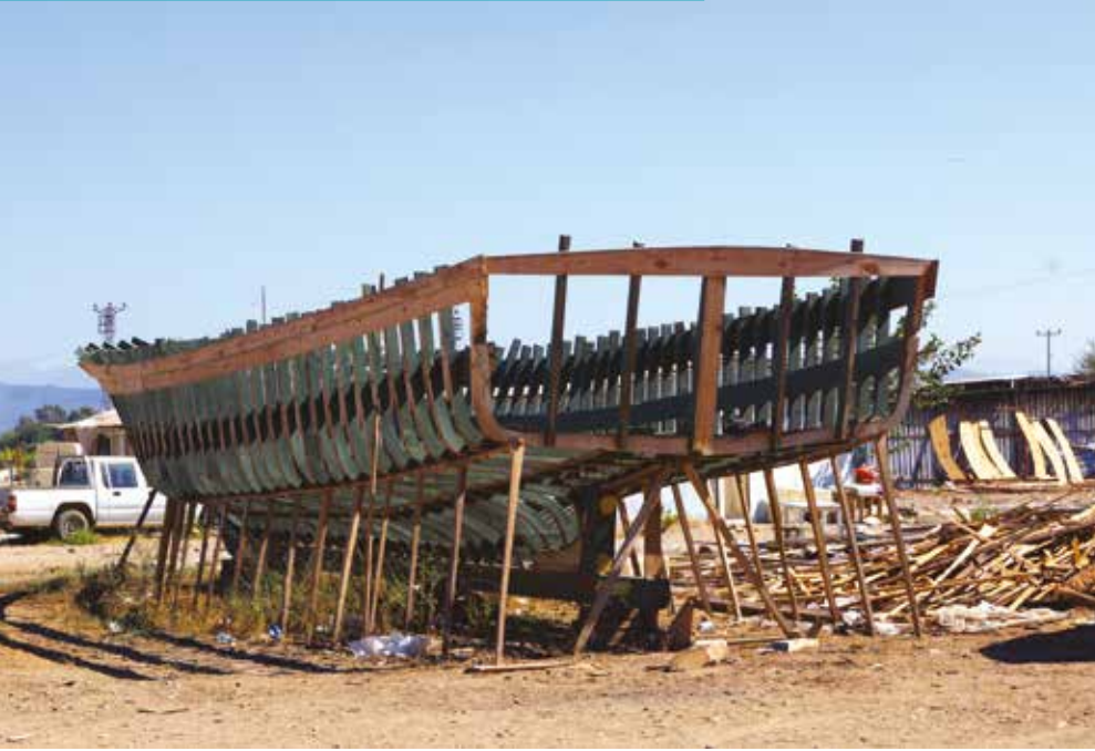
Fotoğraf-6: İnşa edilmekte olan ahşap tekne-Manavgat İlçesi
