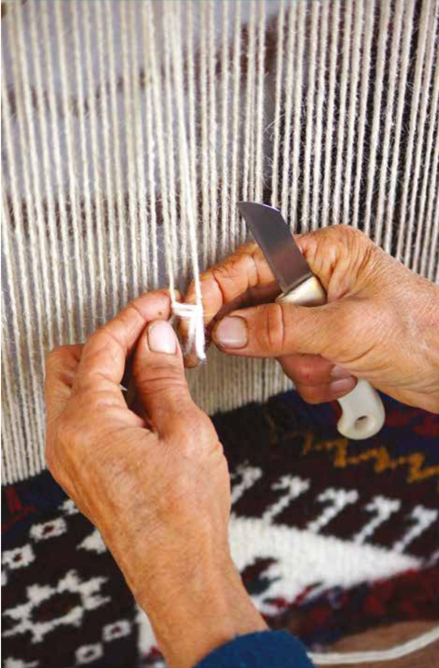
Fotoğraf-130: Dügüm atılması-Döşemealtı İlçesi Kovanlık Mahallesi
