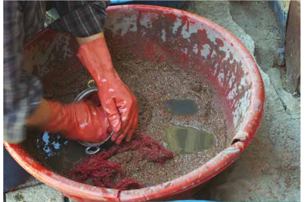
Fotoğraf-206: Kalaylanacak bakır eşyanın kumla temizlenmesi-Elmalı İlçesi
