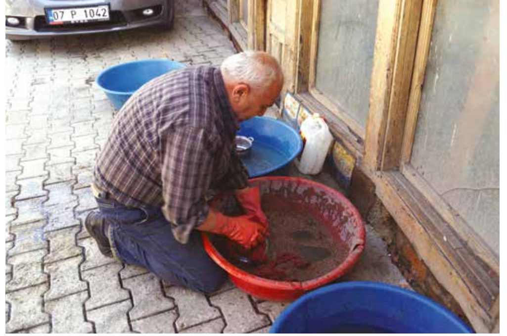
Fotoğraf-204: Kalaylanacak bakır eşyanın kumla temizlenmesi-Elmalı İlçesi
