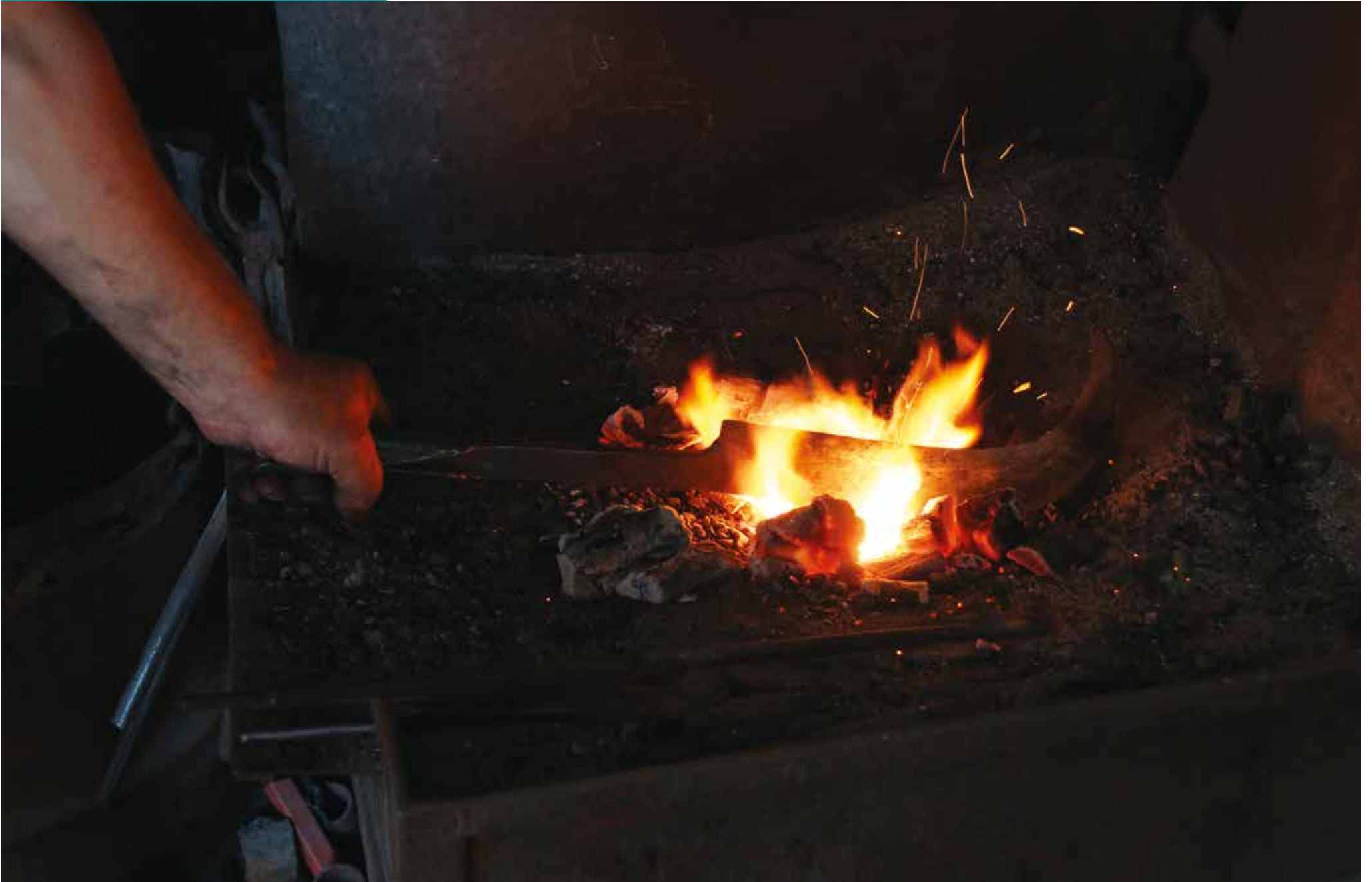
Fotoğraf-96: Demir tahranın yapımı-Muratpaşa İlçesi
