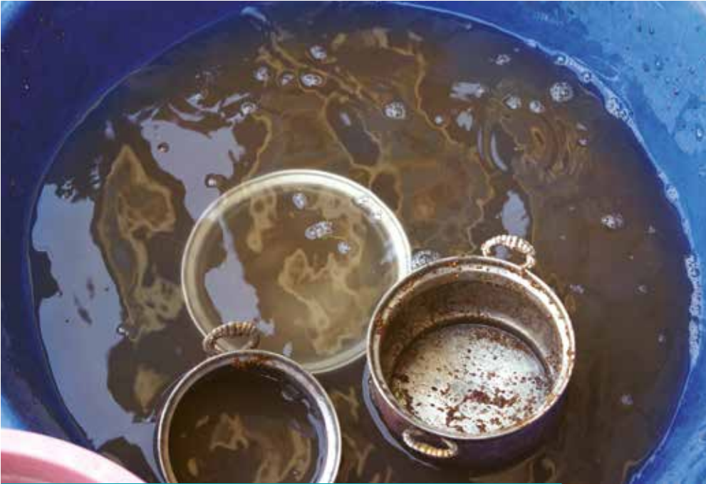
Fotoğraf-205: Kalaylanacak bakır eşyanın kumla temizlenmesi-Elmalı İlçesi
