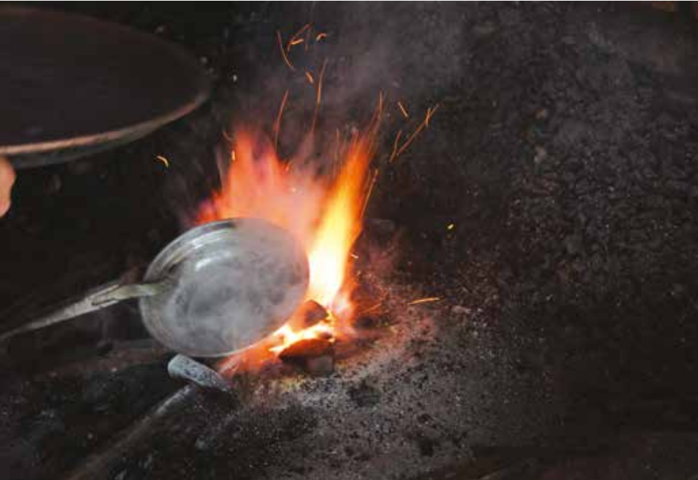
Fotoğraf-209: Bakır tabağın kalaylanması-Elmalı İlçesi
