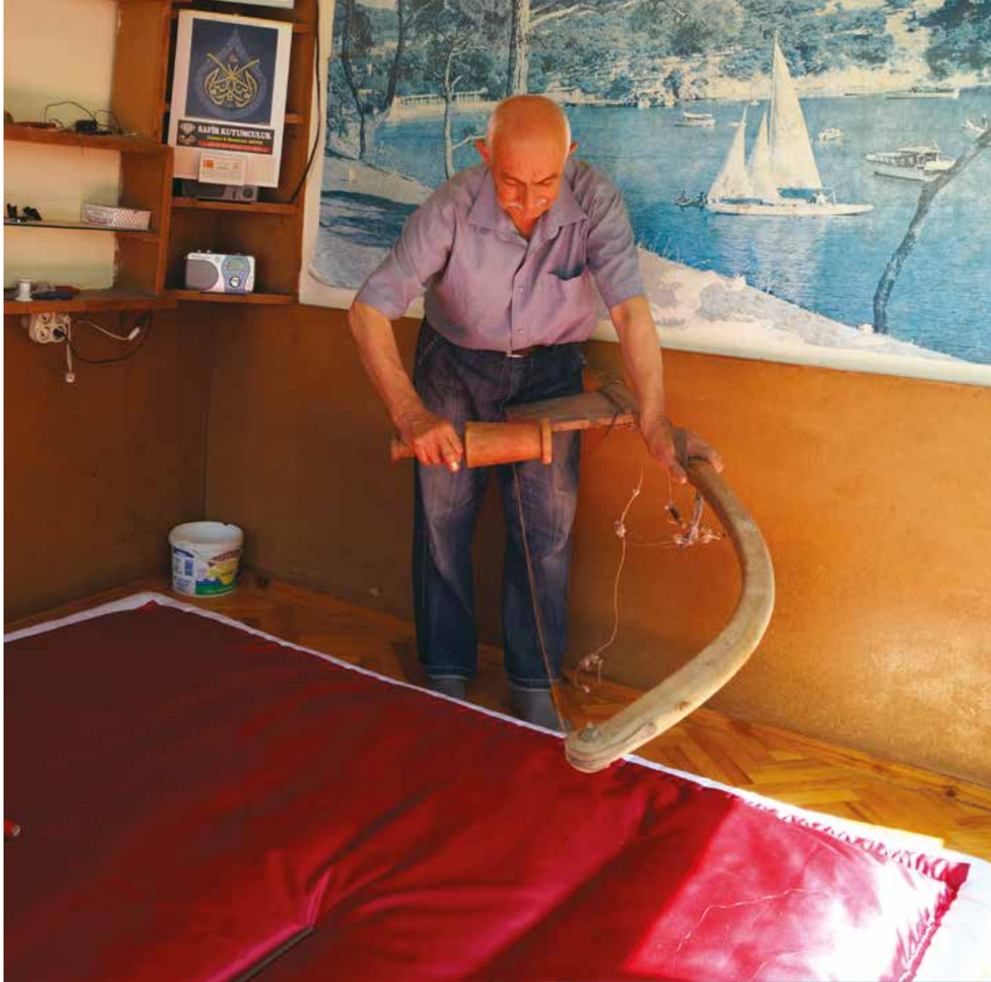
Fotoğraf-312: Hallaç yayı ve tokmağının kullanımı-Elmalı İlçesi
