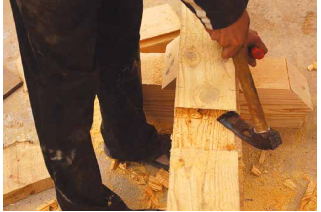
Fotoğraf-7: Teknenin omurga kısmının imal edilmesi-Manavgat İlçesi
