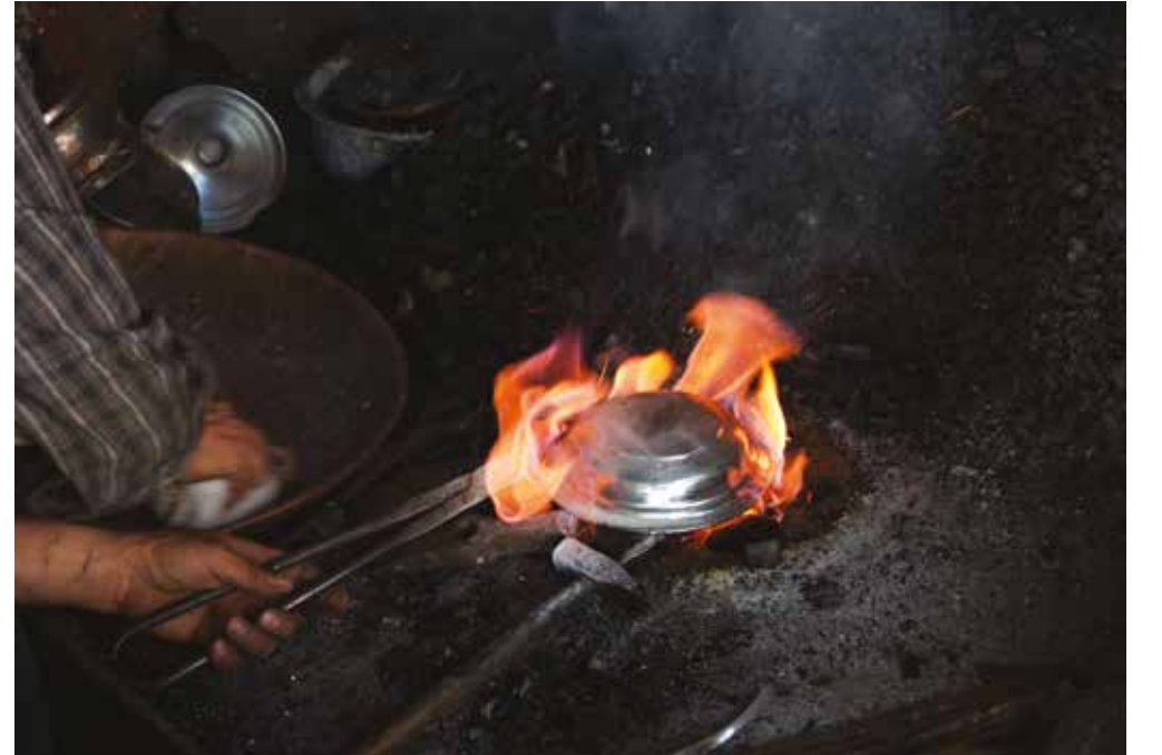
Fotoğraf-210: Bakır tabağın kalaylanması-Elmalı İlçesi
