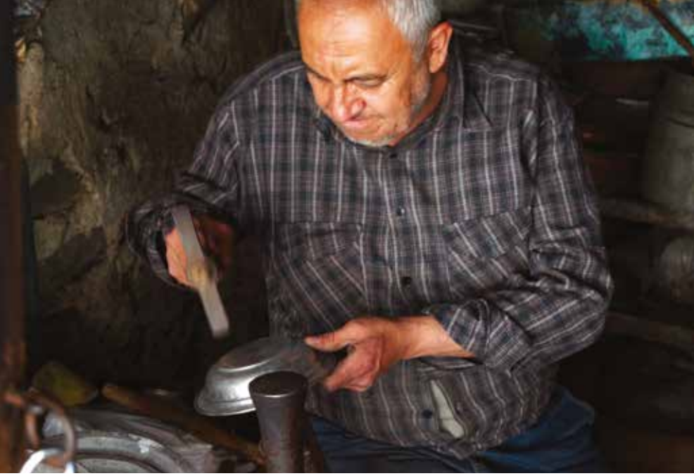
Fotoğraf-207: Kalaylanacak olan bakır eşyanın düzeltilmesi-Elmalı İlçesi
